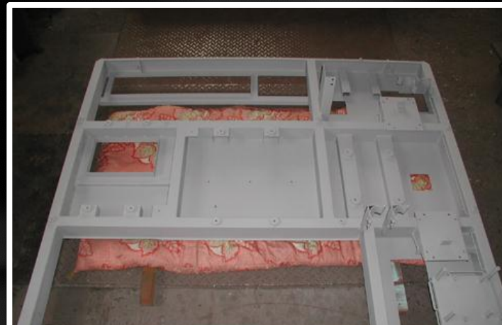
電車空調機フレーム
